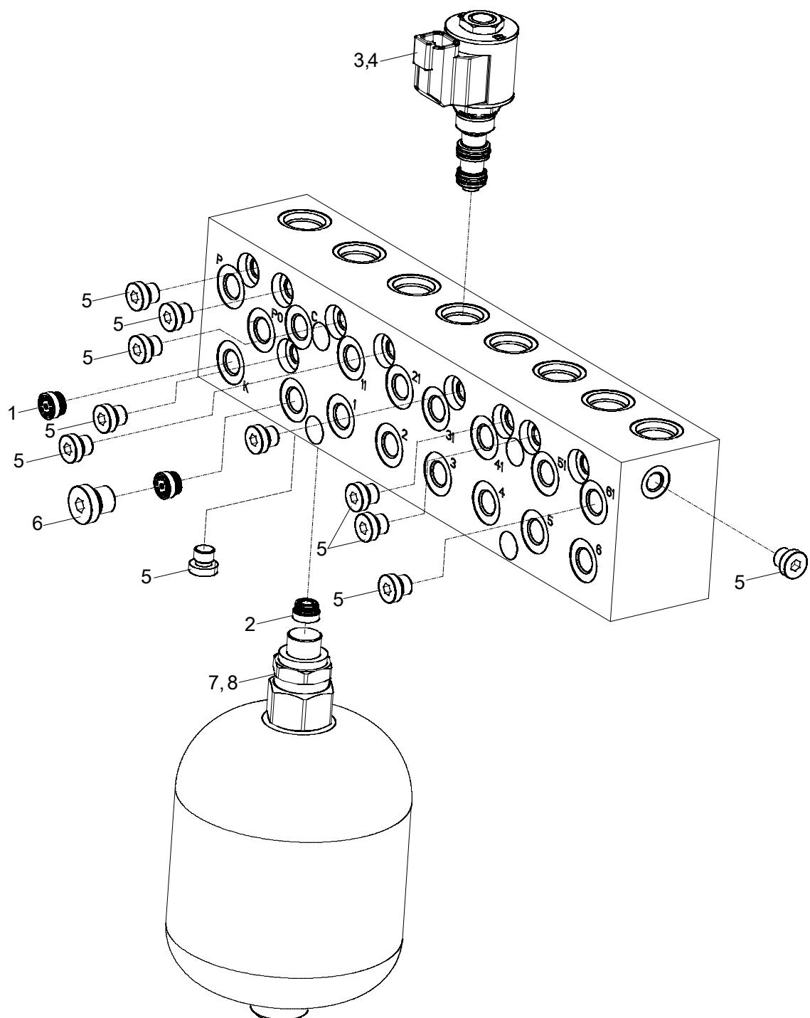
**PILOT-OPERATED CONTROL VALVE BLOCK**
