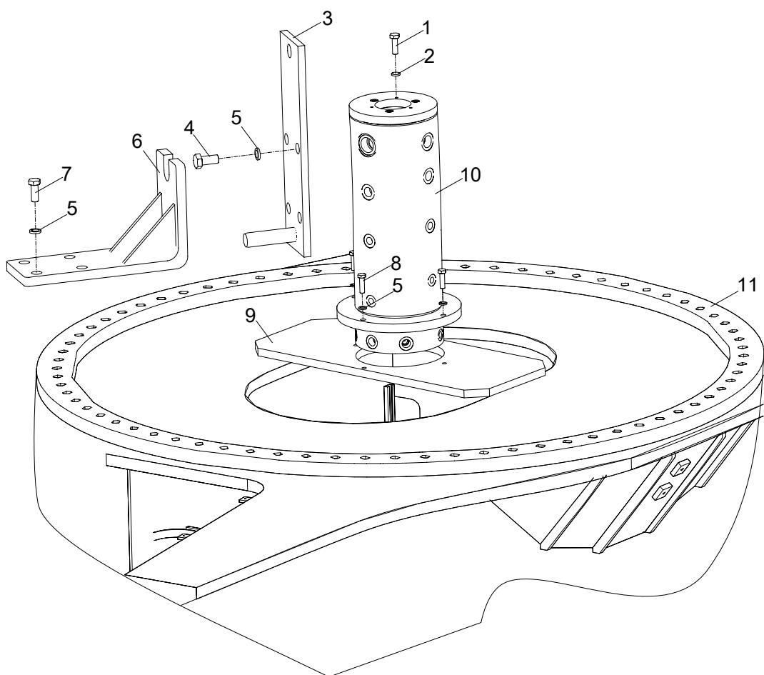
**CENTRE REVOLVING JOINT INSTALLATION
