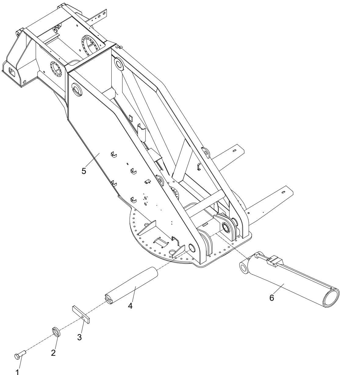
**DERRICKING CYLINDER INSTALLATION
