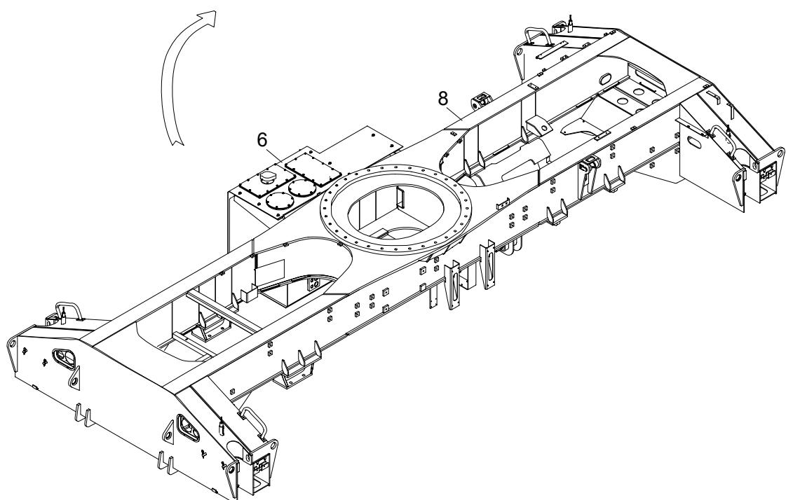
**HYDRAULIC OIL TANK INSTALLATION
