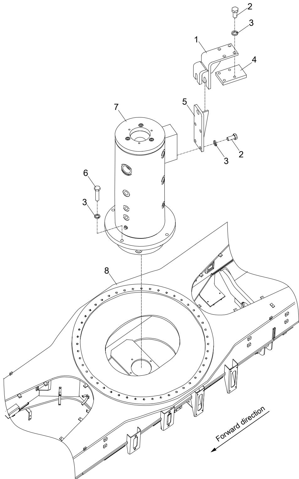
**CENTRE REVOLVING JOINT INSTALLATION
