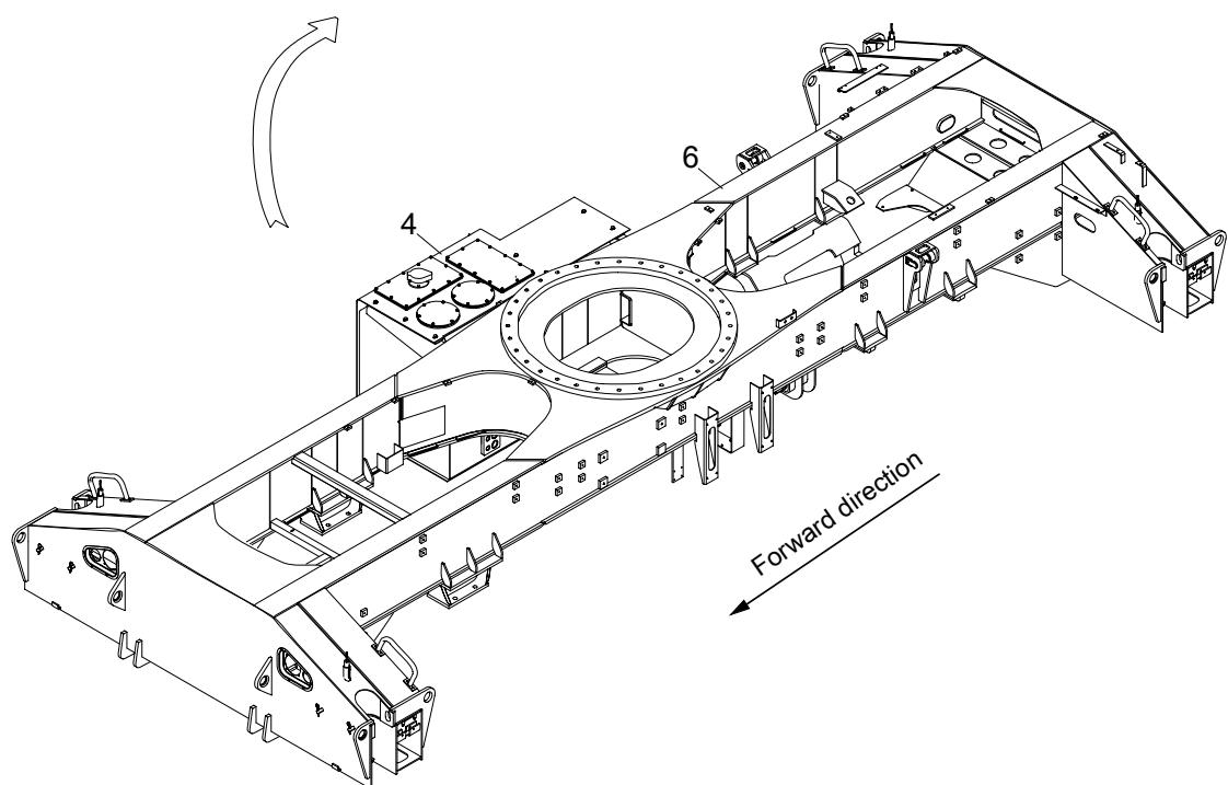
**HYDRAULIC OIL TANK INSTALLATION
