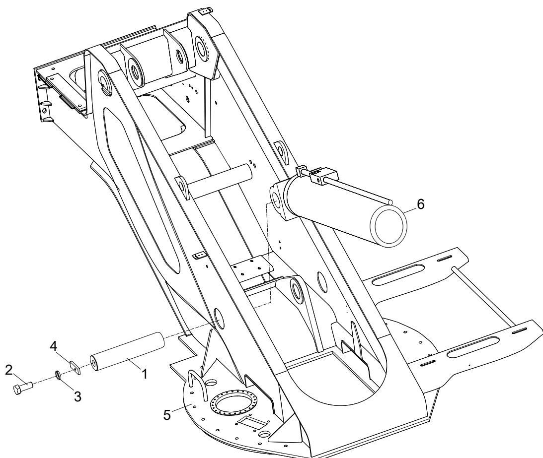
**DERRICKING CYLINDER INSTALLATION
