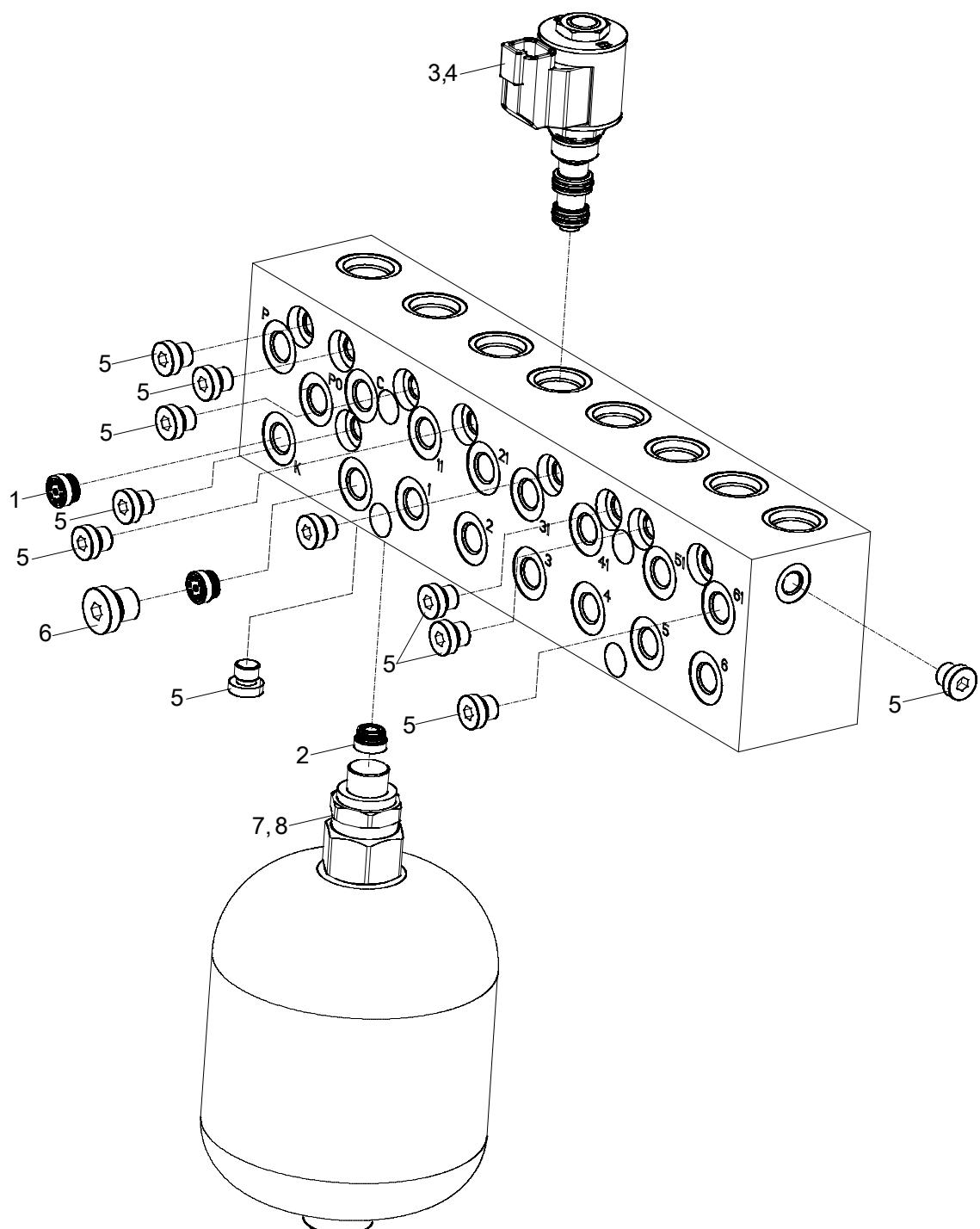
**PILOT-OPERATED CONTROL VALVE BLOCK**
