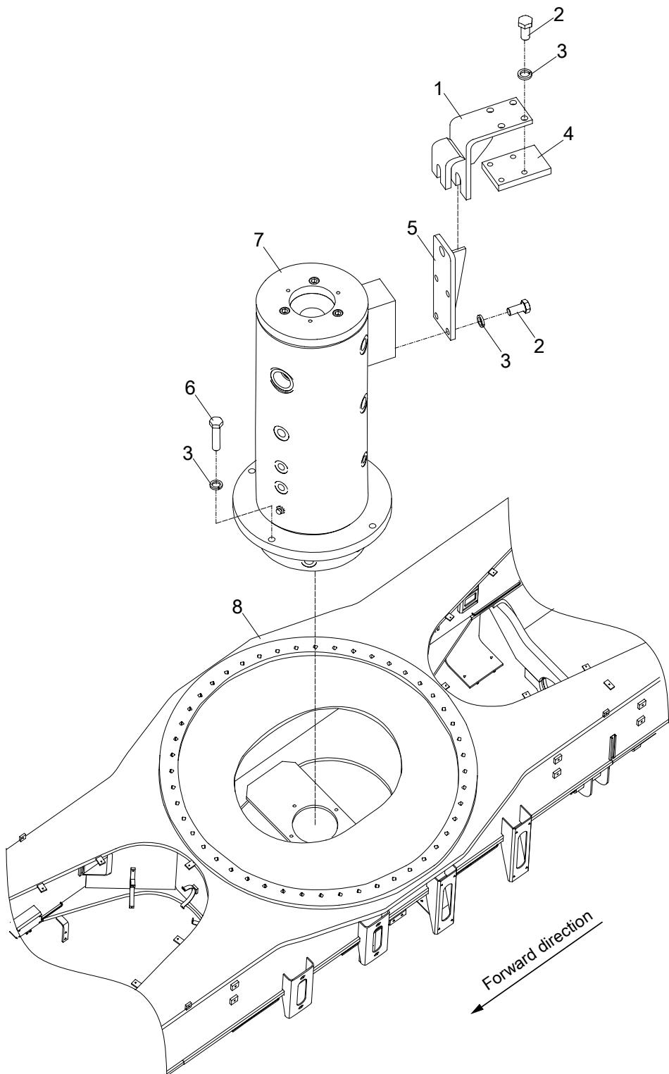
**CENTRE REVOLVING JOINT INSTALLATION
