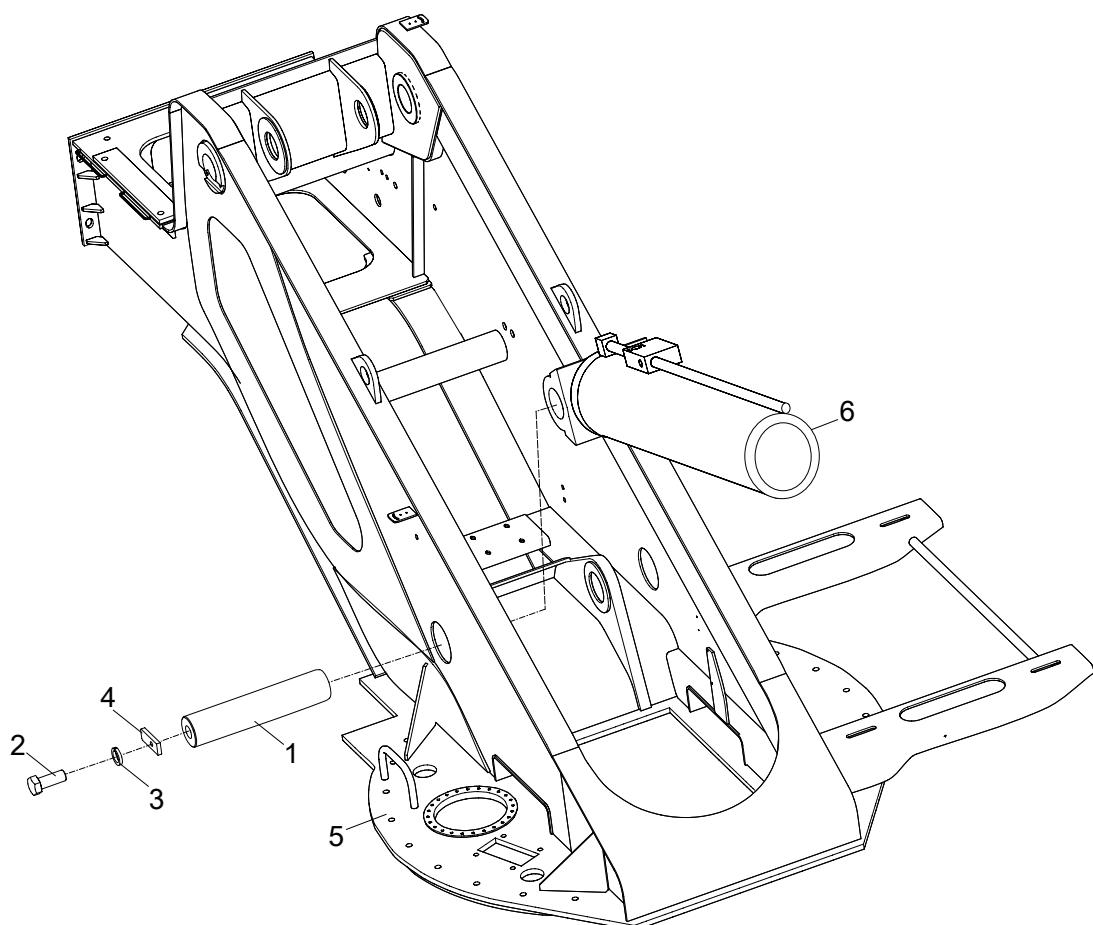
**DERRICKING CYLINDER INSTALLATION
