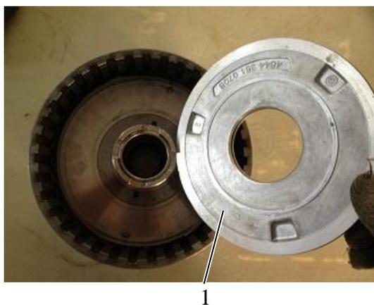
17. Take out the KV clutch piston.
